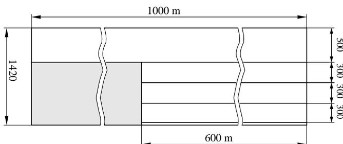
Mit einer Rollenschere sollen aus Blechen von 1420 mm Breite rechteckige Bleche, und zwar mit einer Breite von 500 mm und einer Gesamtlänge von 1000 m sowie mit einer Breite von 300 mm und einer Gesamtlänge von 1800 m geschnitten werden. Bisher wurde nach der beigefügten Zeichnung geschnitten, in der die graue Fläche den Abfall darstellt, der ziemlich groß ist.
